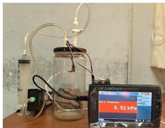
Figura 8. Registro de datos a diferentes niveles de presión barométrica
