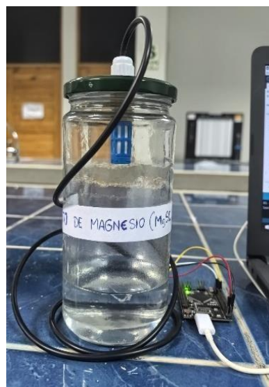
Figura 6. Sensor de humedad SHT40 expuesto al vapor de la solución de MgSO_4
